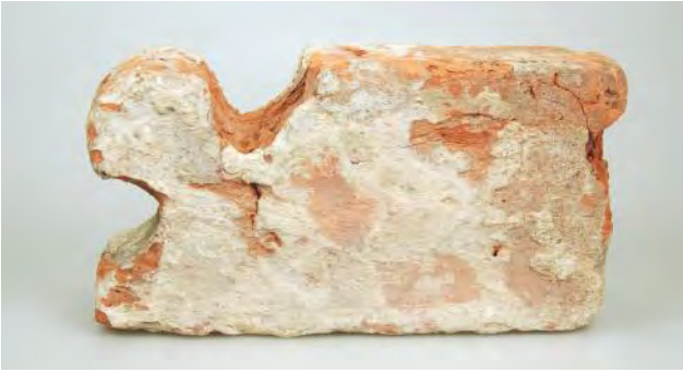
3 Bakstenen profielsteen, afm. 32,8x17,9x8,1 cm.
