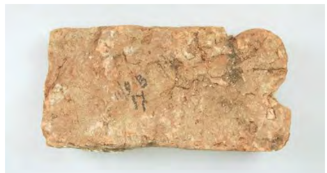
2 Bakstenen profielsteen, afm. 28,5x14x7,2 cm.
